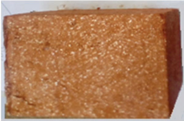
Рис. 1. Облегченный композиционный керамический материал со вспученным вермикулитом
