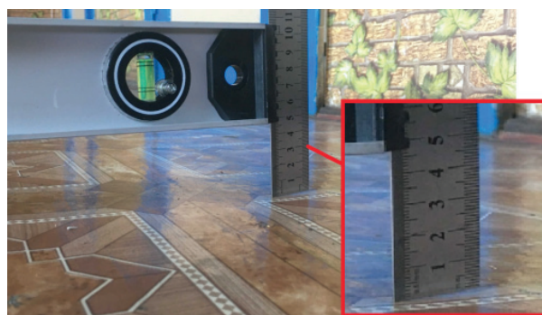
Рис. 5. Деформации пола на кухне 1 этажа
