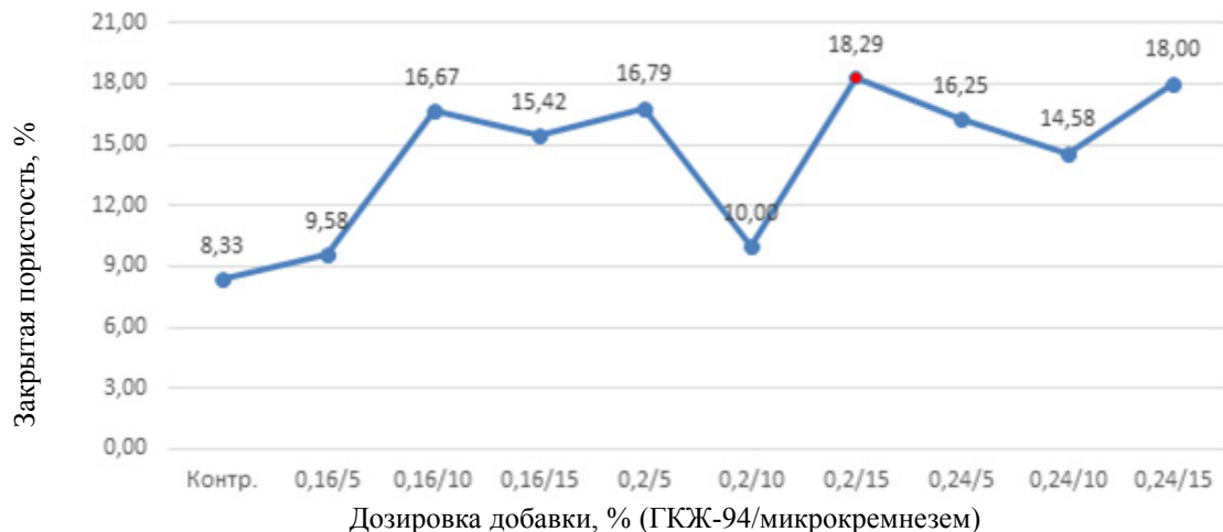
Рис. 2. Зависимость закрытой пористости образца от дозировки модификатора эмульсии ГКЖ-94 и суспензии микрокремнезема на 28 сутки
