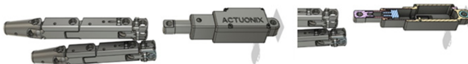
Рис. 4. Модель протеза пальцев, реализованная в Autodesk Fusion 360, и срез двигателя Actuonix
