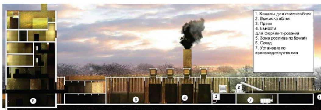
Рис. 3. Проект реконструкции мельницы под предприятие по производству сидра, разрез 1, архитектор Ник Джонс, 2007
