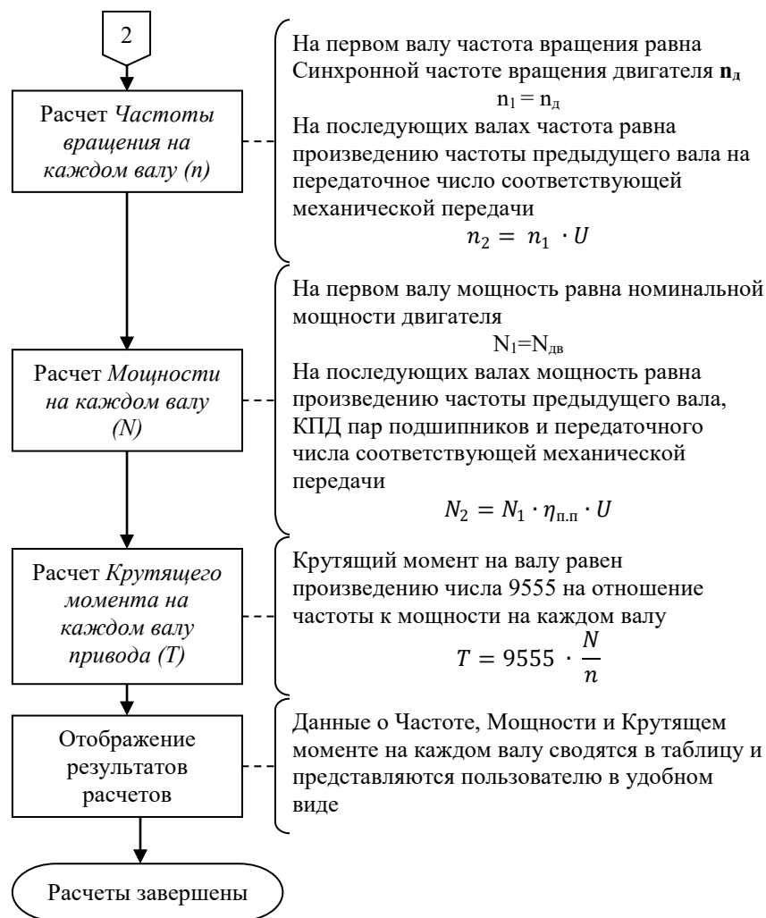
Рис. 2. Алгоритм функционирования системы поддержки принятия решения
