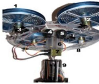
Рис. 1. Стенд «Квадрокоптер»: 1 – пропеллер в защитном кожухе; 2, 3 – двигатели постоянного тока; 4, 5, 6 – цифровые датчики углов (энкодеры); 7 – плата питания двигателей и энкодеров; 8 – основание; 9 – токосъемное кольцо
