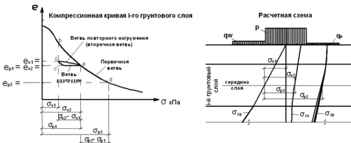
Рис. 2. Определение модулей деформации E_{si} и E_{pi}
