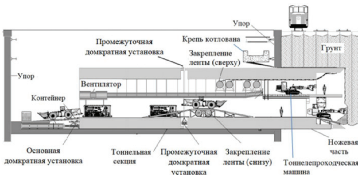
Рис. 2. Технологическая схема продавливания тоннеля
