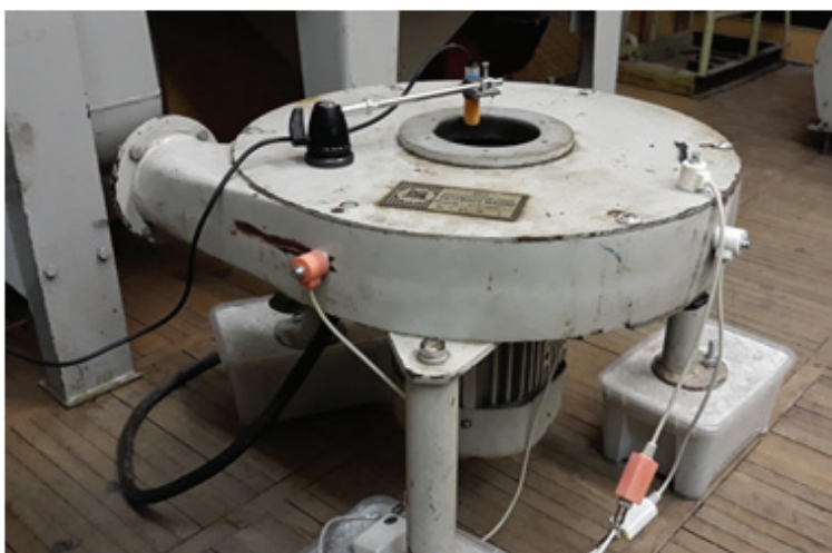
Рис. 1. Измерение параметров вибрации энтолейтора РЗ-БЭР
