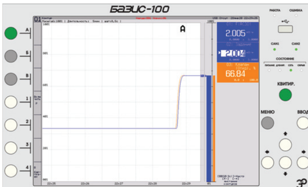
Рис. 4. Настройка контура регулирования расхода воды через змеевик с купонами коррозии
