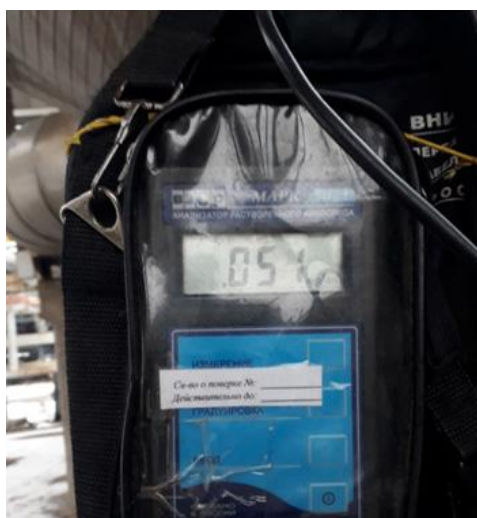
Рис. 3. Количественное содержание кислорода в подпиточной воде при отключенном дегазаторе
