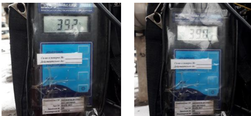
Рис. 4. Температура подпиточной воды при отключенном дегазаторе
