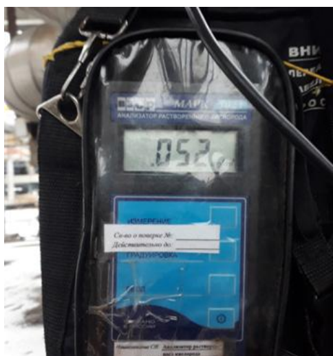
Рис. 3. Количественное содержание кислорода в подпиточной воде при отключенном дегазаторе
