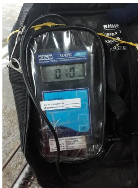
Рис. 2. Количественное содержание кислорода в подпиточной воде при работе дегазационной установки
