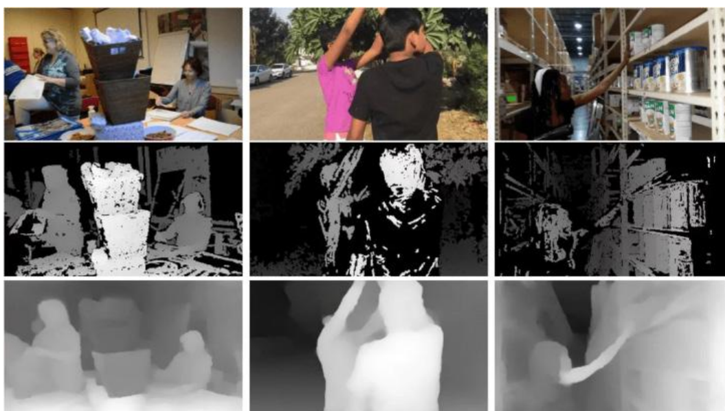
Рис. 2. Принцип реализации метода на основе данных глубины
