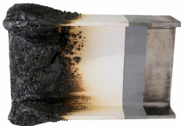
**Рис. 2.** Огнезащитное интумесцентное покрытие
