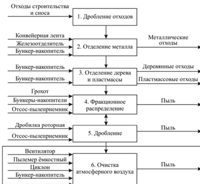
Рис. 3. Линия переработки отходов строительства и сноса
