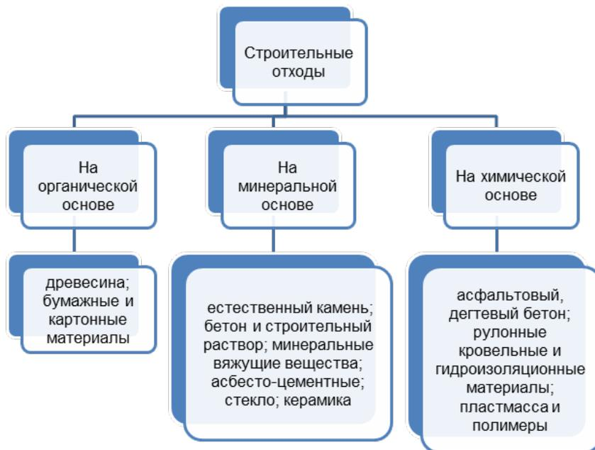
Рис. 2. Классификация строительных отходов, пригодных для вторичного использования (рециклинг) по типам основы
