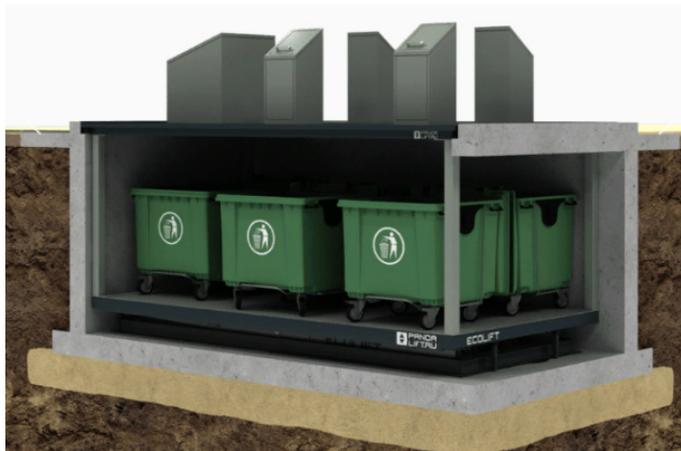
Рис. 1. Устройство мусорной площадки в трехмерном представлении
