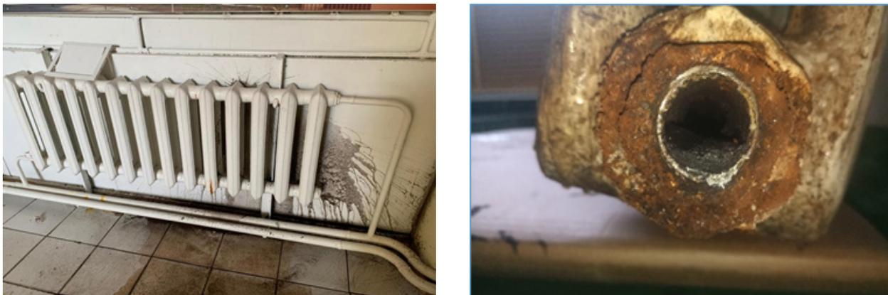
Рис. 1. Разрушение отопительного прибора
