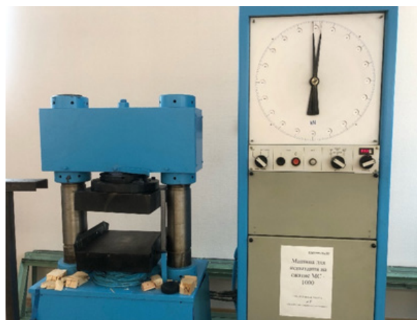
Рис. 1. Испытательная установка для испытания глиняного кирпича на сжатие
