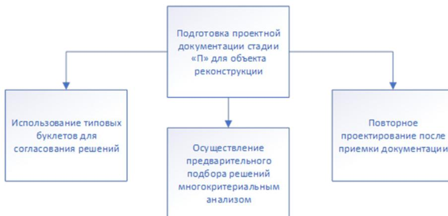
**Рис. 1.** Схема решений, способствующих сокращению срока производства работ
