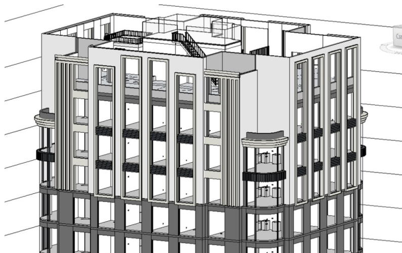
Рис. 2. Размещенная облицовка на проектируемом здании
