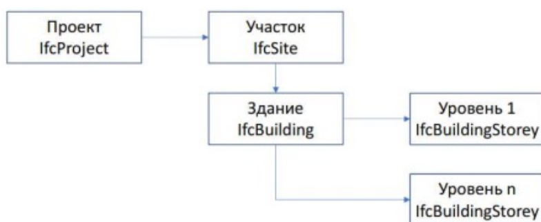
Рис. 8. Структура ЦИМ в файле формата «ifc»
