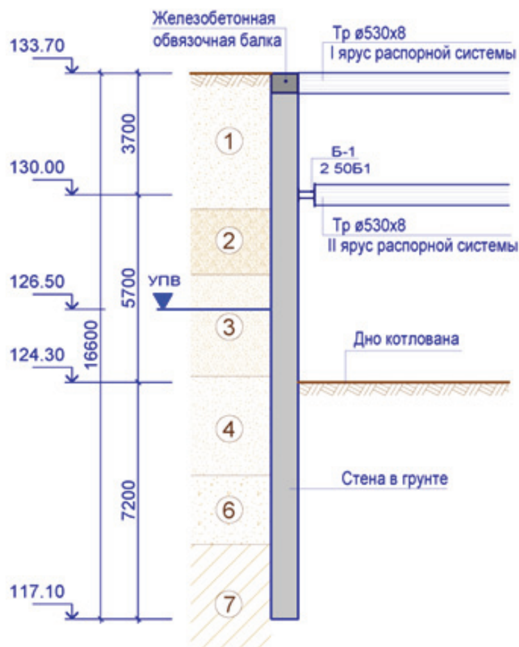
Рис. 1. Разрез по котловану проектируемого здания
