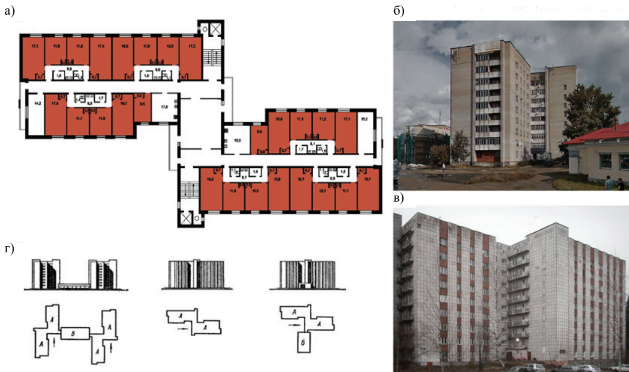
Рис. 3. Типовой проект общежития для общесоюзного применения (серия 164-80-4) а) – план типового этажа; б) – общежитие № 2 Северного государственного медицинского университета в г. Архангельск; в) – общежитие № 1 Пермского национального исследовательского политехнического университета в г. Пермь; г) – применявшиеся варианты компоновки секций в плане
