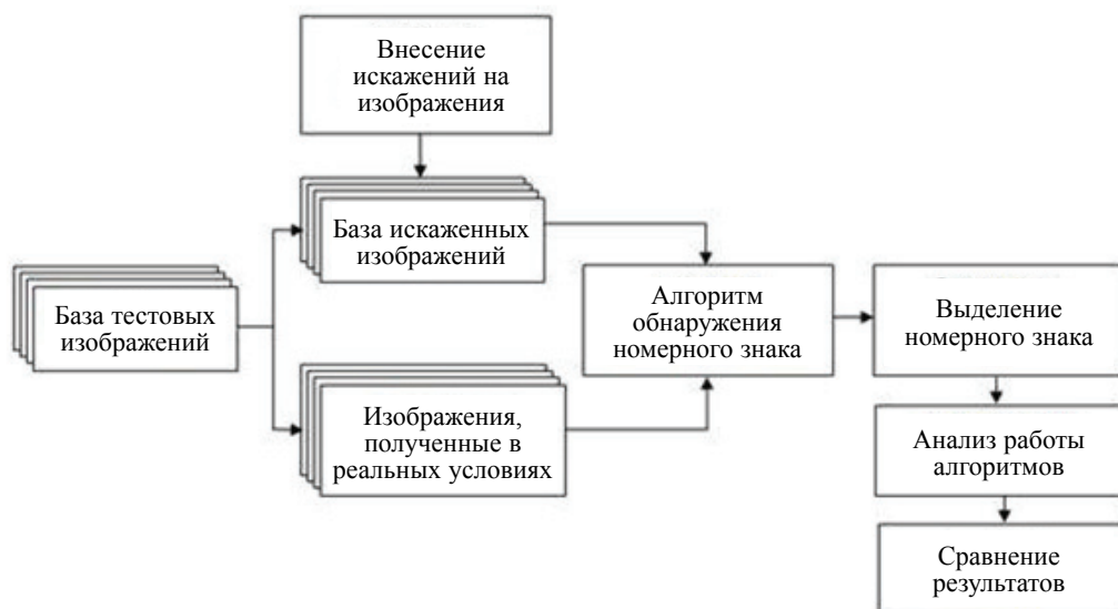
Рис. 1. Схема исследования алгоритмов обнаружения номерных знаков
