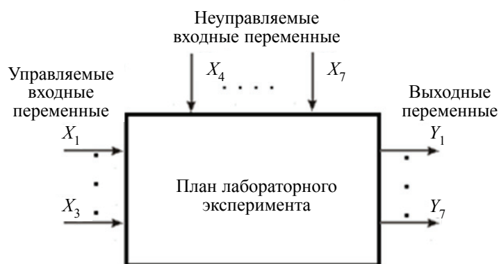
Рис. 1. Модель исследования оптических характеристик почвы в зависимости от содержания в ней гумуса
