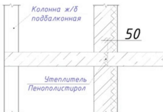
Рис. 2. Разрез конструктивного решения устройства балкона
