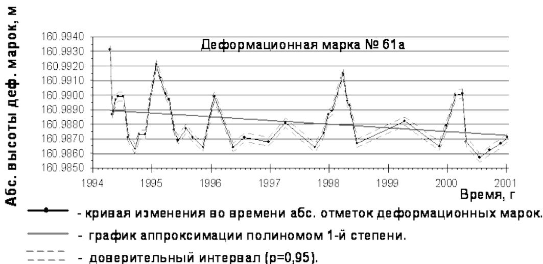
**Рис. 1.** График многолетних геодезических наблюдений за деформациями фундаментов Останкинского дворца
