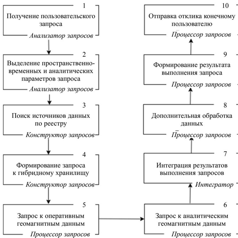
Рис. 2. Схема обработки пользовательского запроса
