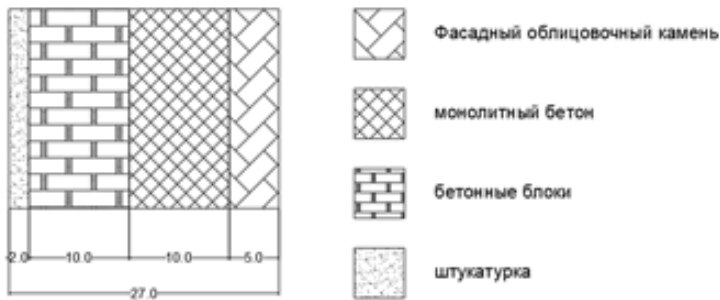
Рис. 10. Разрез стены современного здания
