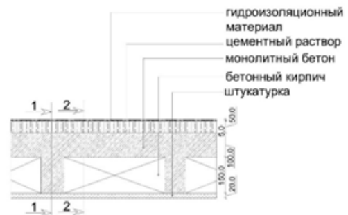
Рис. 11. Разрез крыши современного здания
