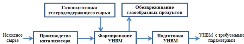
Рис. 1. Декомпозиция производства УНВМ методом ГФХО
