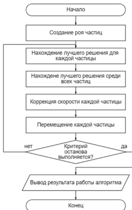
Рис. 1. Блок-схема работы алгоритма роя частиц
