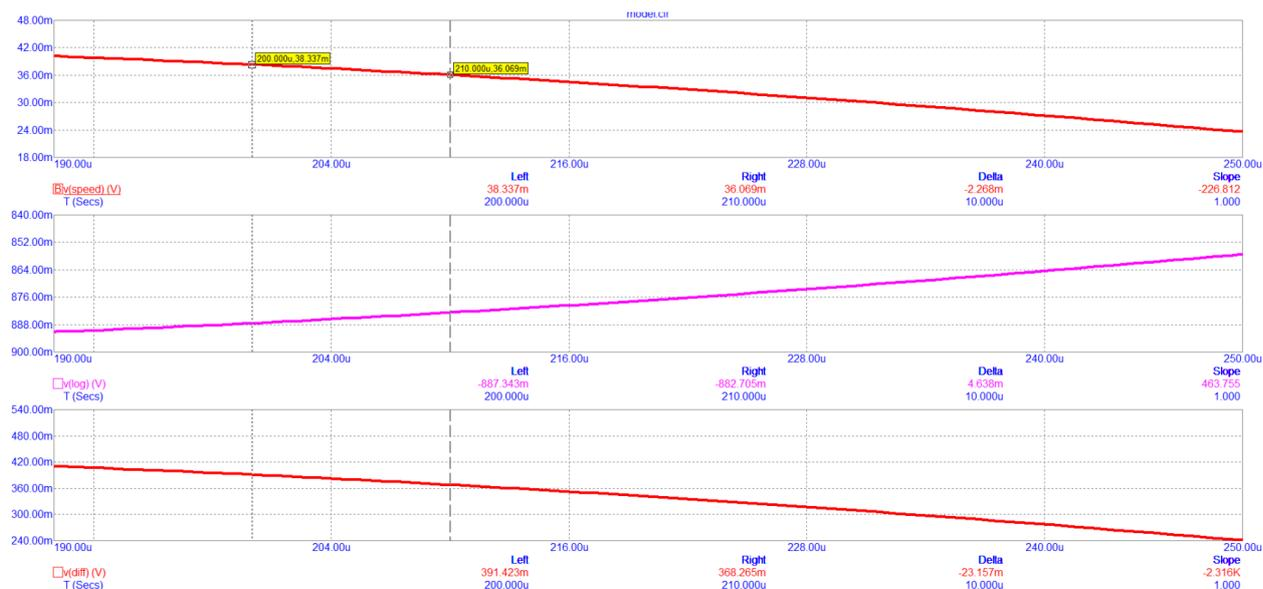
Рис. 5. Результаты анализа переходных процессов в ЭДУ индукционных датчиков при движении тела со скоростью 10 км/с
