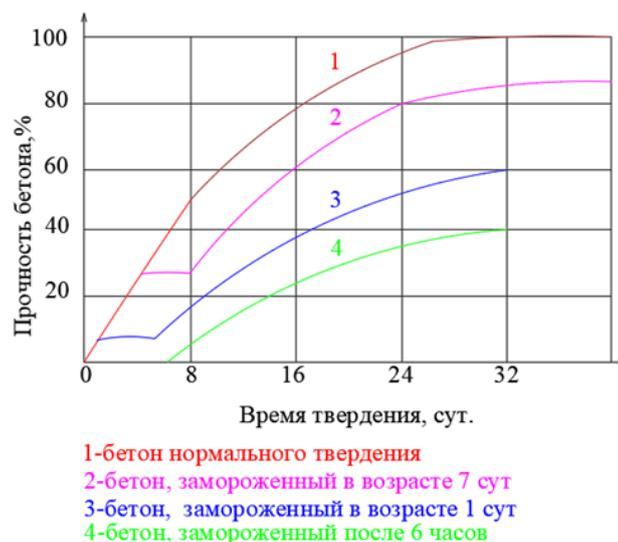
Рис. 1. Режимы твердения бетона
