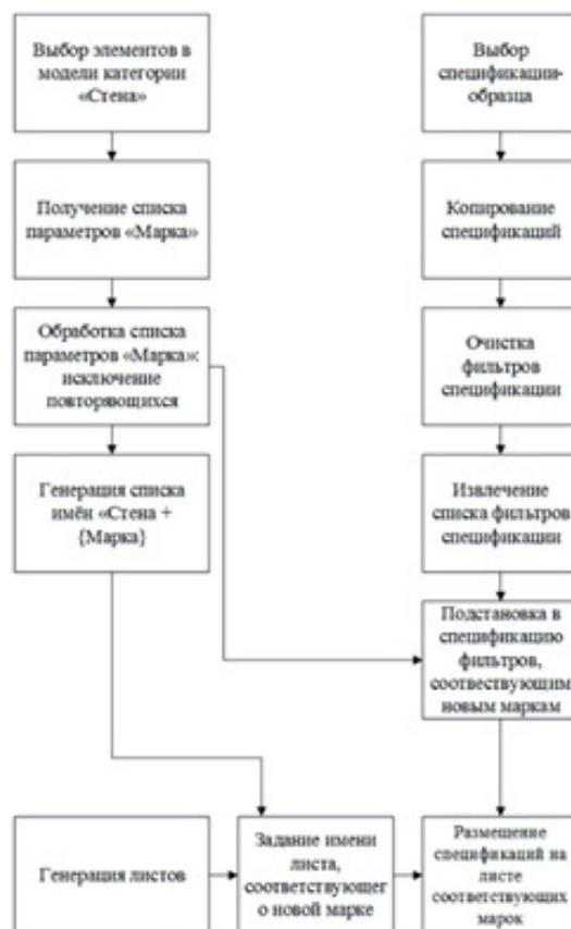
Рис. 1. Блок-схема последовательности работы скрипта
