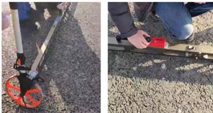
Рис. 2. Измерение дефектов дорожного покрытия
