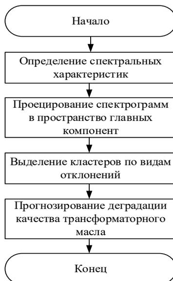
Рис. 1. Алгоритм методики экспресс-контроля качества трансформаторного масла
