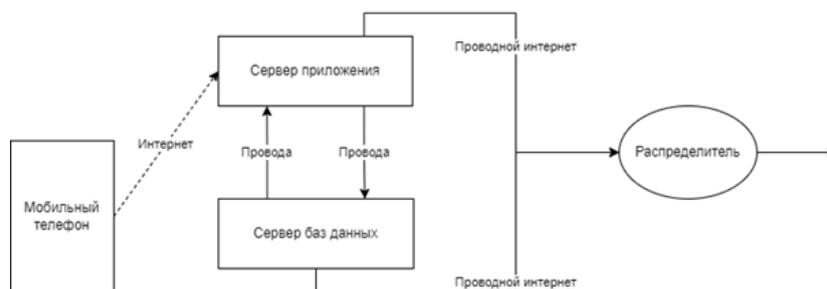
Рис. 1. Аппаратная архитектура системы
