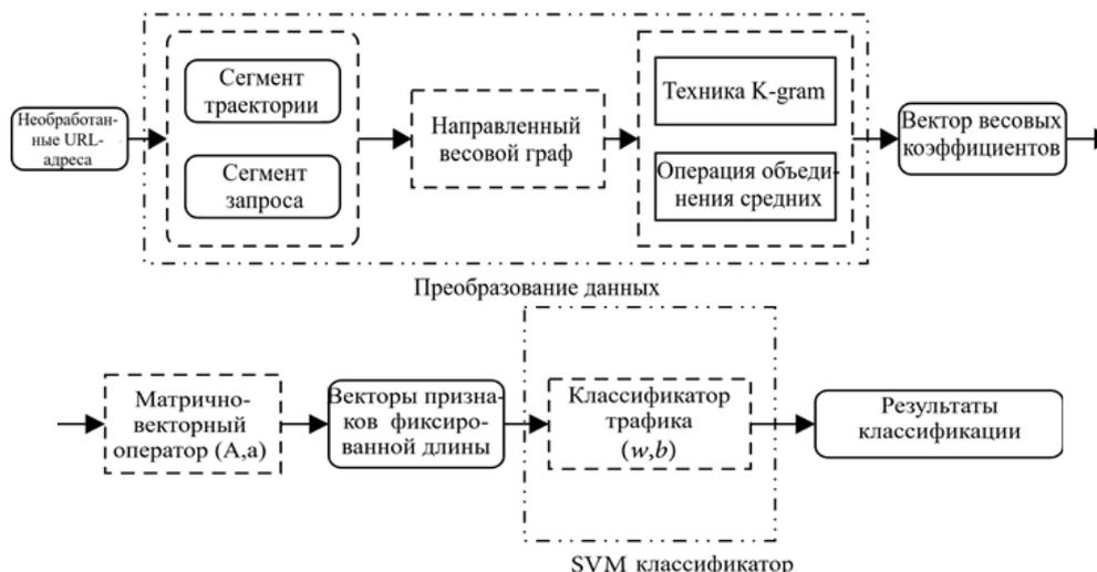
Рис. 2. Общая структура модели обнаружения аномалий трафика
