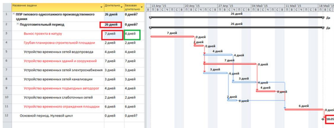
Рис. 5. Результат последствий проявлений случайного негативного фактора в ходе инженерно-технической подготовки строительства
