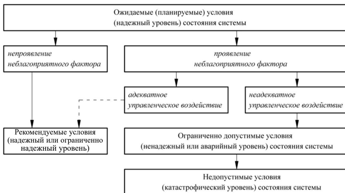
**Рис. 2.** Схема анализа последствий возможных проявлений негативных факторов
