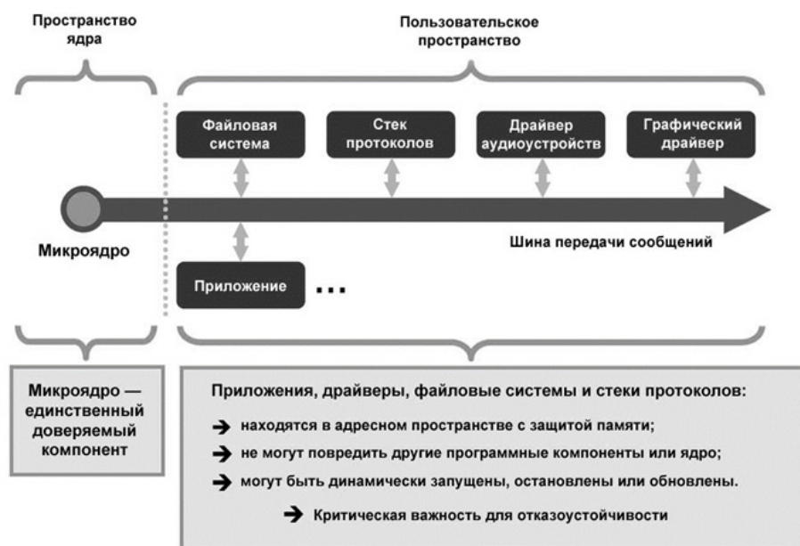
Рис. 1. Микроядерная архитектура QNX Neutrino
