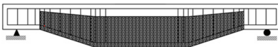
Рис. 3. Балка ( NHB-C2 ) с усилением углепластиком вокруг балки
