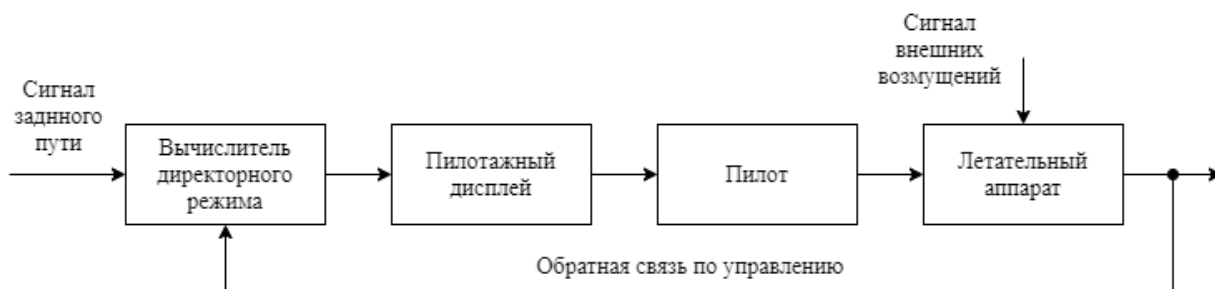
Рис. 1. Система директорного управления
