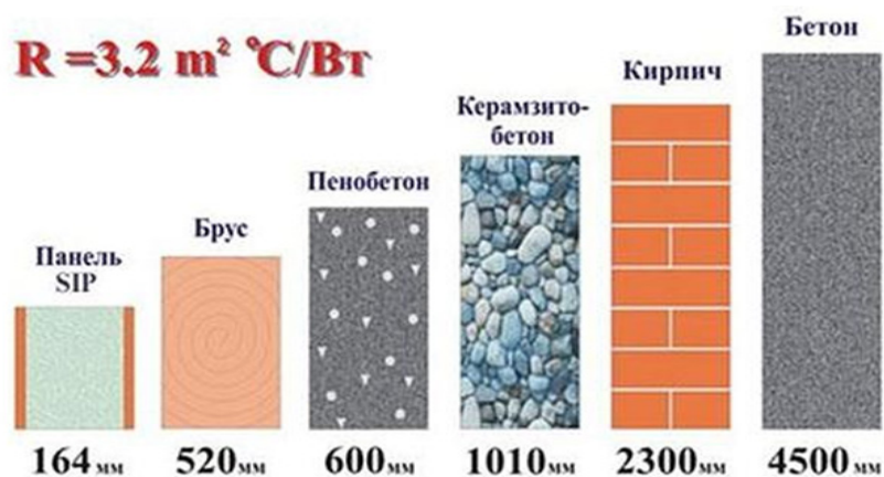
Рис. 3. Приведенное сопротивление теплопередачи для различных конструкций стен
