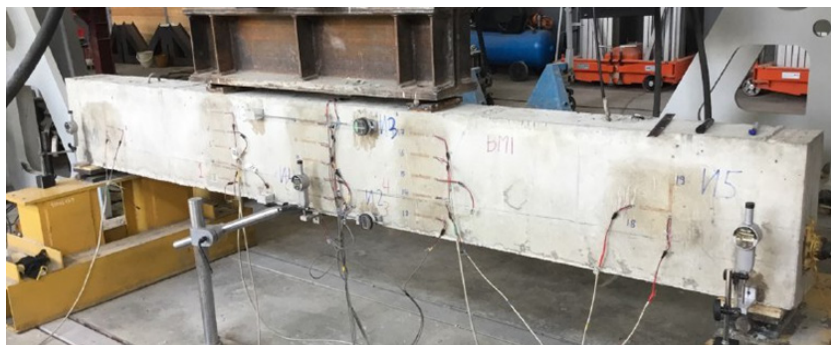
Рис. 5. Испытание экспериментальной балки первой серии со сцеплением с бетоном
