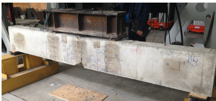
Рис. 4. Выпрямление образца второй серии после снятия домкрата
