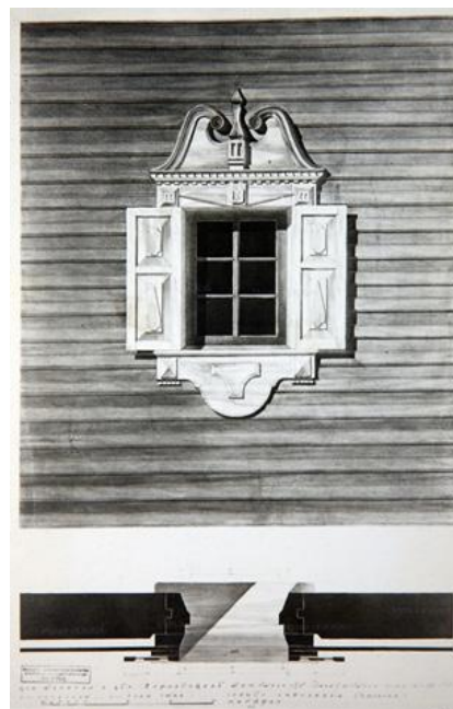
Рис. 15. Дом Клопова из деревни Потаневщина. Наличник окна (обмерный чертеж). Тех. арх. Д.Г. Сафонова, 1950 г.
