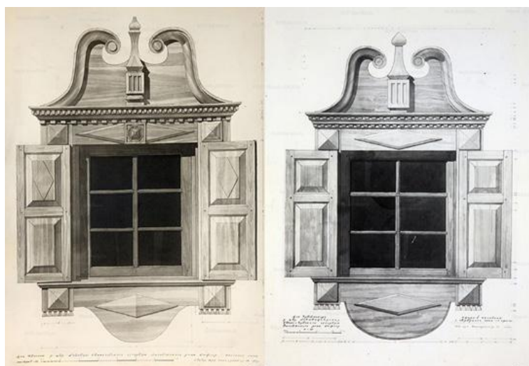
Рис. 11. Дом Лепсина из деревни Кузнецы 1880 г. (слева) и дом Грешникова из деревни Обельщина (справа). Наличники окна (обмерные чертежи). Арх. А.В. Ополовников. 1949 г. (Из чертежей А.В. Ополовникова в фондах музея-заповедника «Кижь» (V. Памятники гражданской архитектуры) [37])
