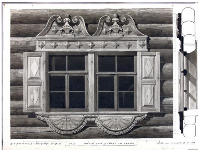
Рис. 12. Дом Васькина из деревни Шелтозеро. Наличник двойного окна в сенях 2-го этажа (обмерный чертеж). Арх. А.В. Ополовников. 1954 г. (Из чертежей А.В. Ополовникова в фондах музея-заповедника «Киж» (V. Памятники гражданской архитектуры) [37])
