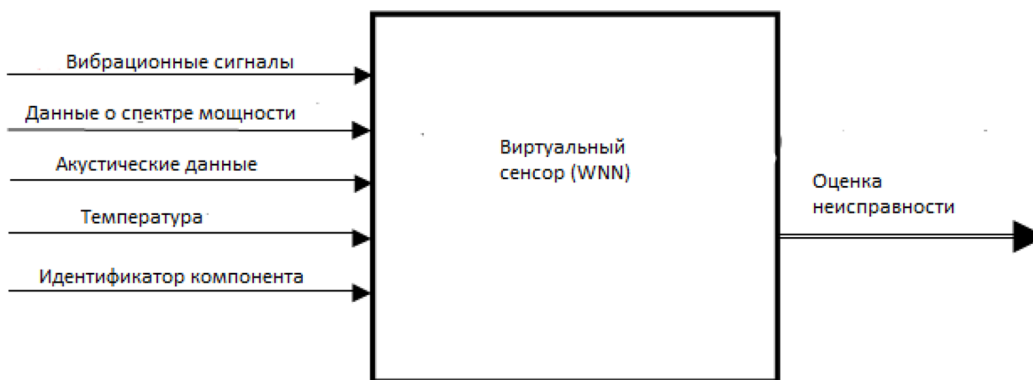
Рис. 3. Схематическое изображение WNN как виртуального датчика
