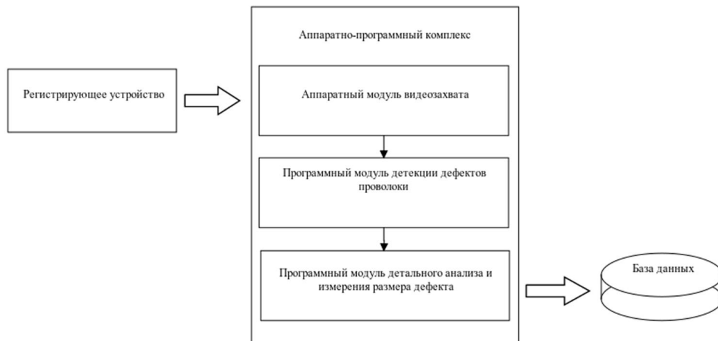
Рис. 4. Двухэтапный алгоритм распознавания дефектов проволоки
