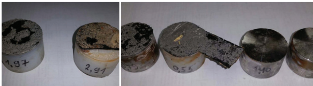
Рис. 2. Образцы эпоксидных полимеркомпозитов а) с наполнителем: слева 5,0 %, справа 10,0 %; б) серия контрольных образцов (без наполнителя)
