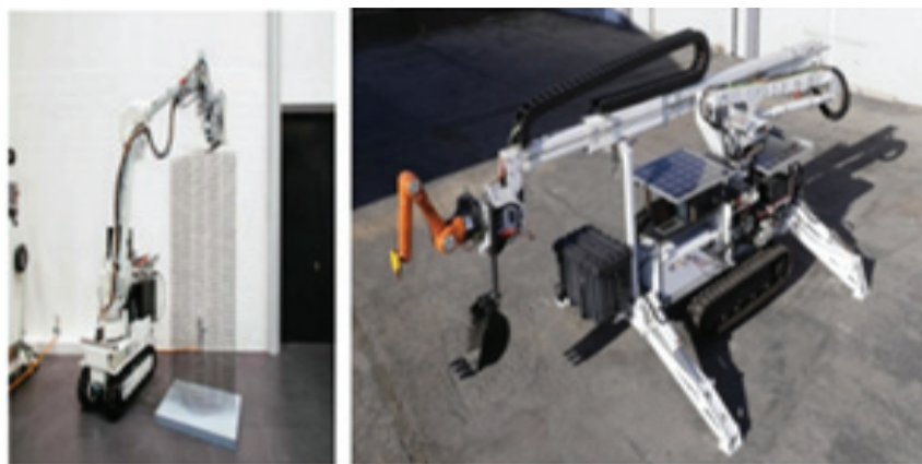
Рис. 2. Мобильный самоходный принтер на гусеничном ходу
