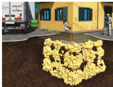
Рис. 4. Вмешательство с технологией Uretex Deep Injection : а) сверление отверстий; б) установка металлических труб
