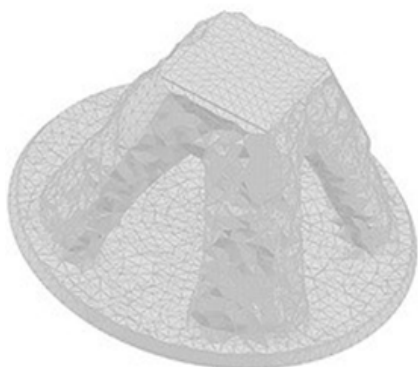
Рис. 1. Топологическая оптимизация модели фундамента
