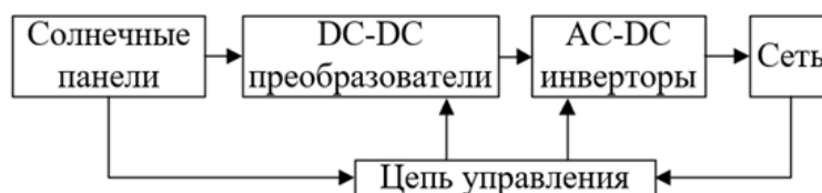
Рис. 1. Структурная схема типичной солнечной электростанции, подключенной к сети
