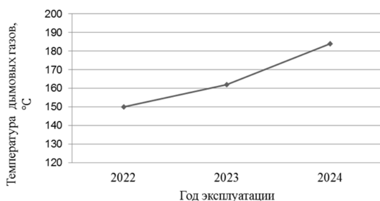
Рис. 5. Динамика увеличения температуры дымовых газов на выходе из котла ПКК-75/24
