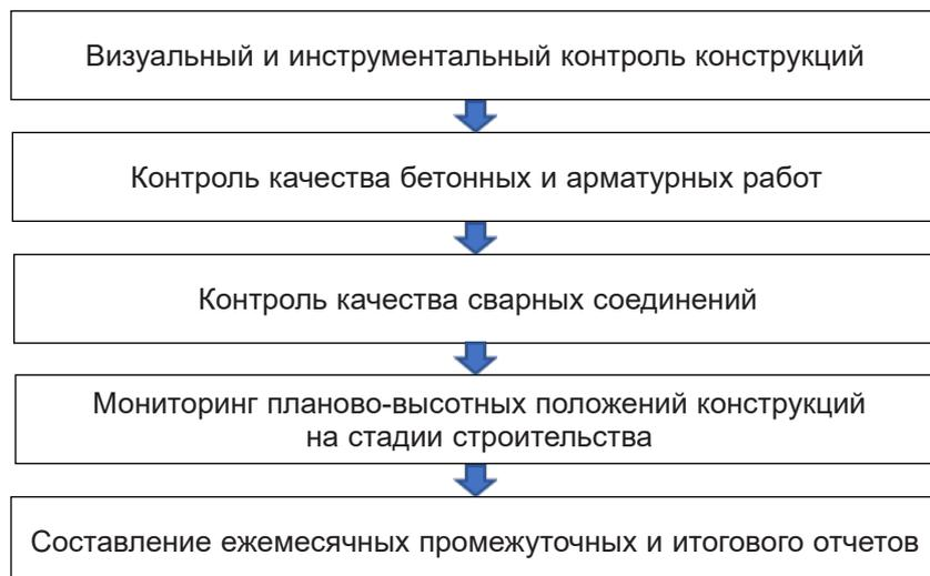
Рис. 1. Схема состава работ по техническому мониторингу
