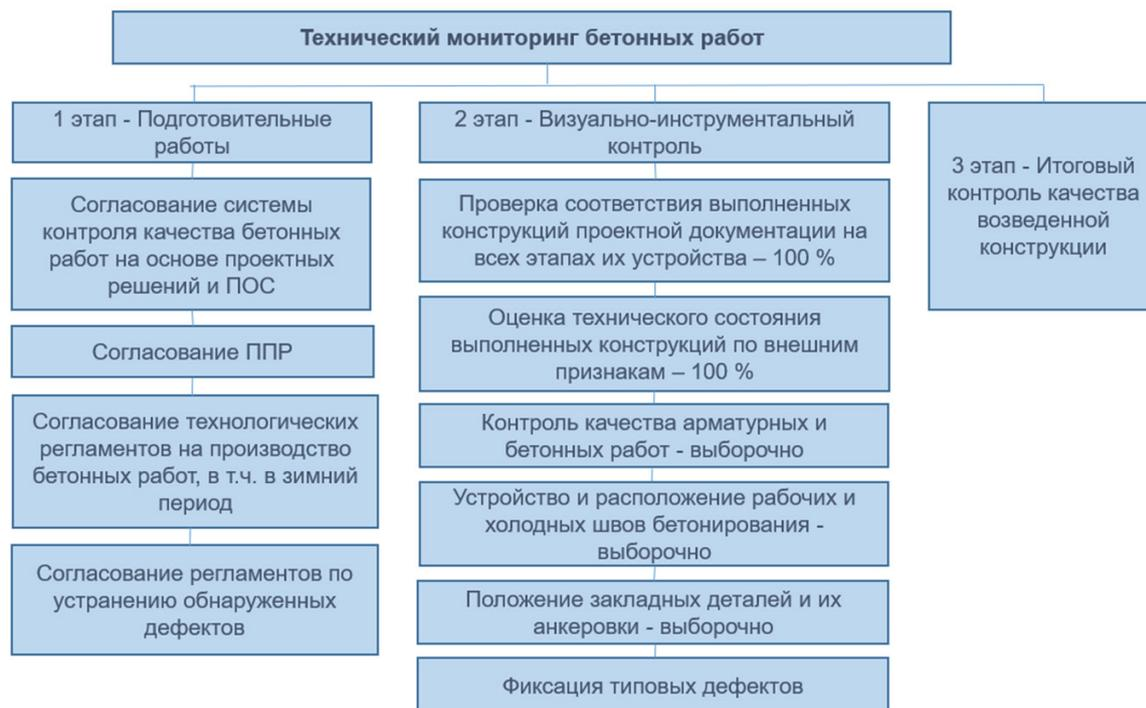
**Рис. 2.** Этапы технического мониторинга бетонных работ
