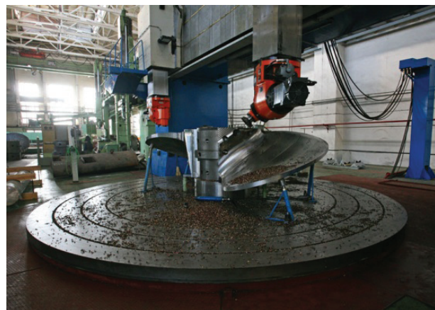
Рис. 3. «Горизонтальная» схема обработки лопасти («ОАО «ЦС «Звездочка», Россия)»
