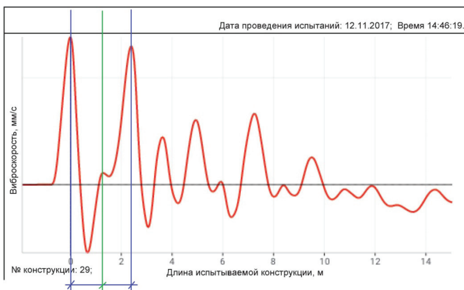
Рис. 3. Преобразованная диаграмма по результатам испытаний сваи
