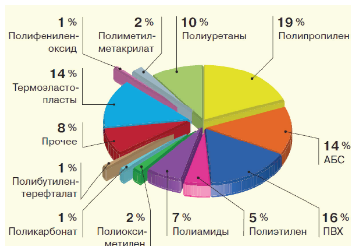
Рис. 2. Структура использования полимерных композиционных материалов в современном машиностроении
