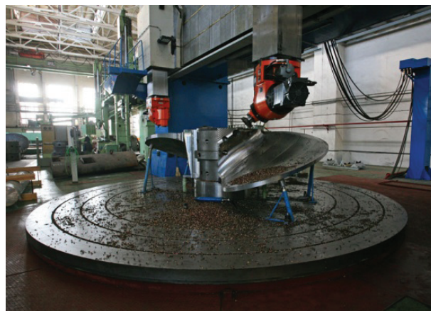
Рис. 1. Схемы обработки лопасти: а) «Вертикальная» схема обработки лопасти ( Mecklenburger Metallguss GmbH (MMG) , Германия); б) «Горизонтальная» схема обработки лопасти на специализированном станке TDP 70/110 («ОАО «ЦС «Звездочка», Россия)
