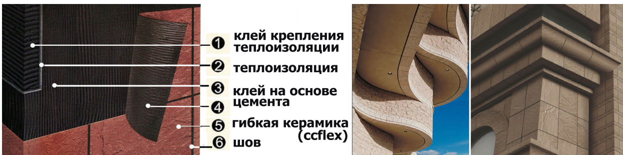
Рис. 2. «Гибкая керамика» или «сflex» – более легкая по весу и способу монтажа альтернатива натуральной керамической облицовке
