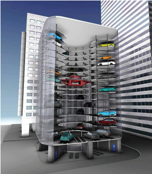
Рис. 2. Автоматическая парковка Skyline T-Park
