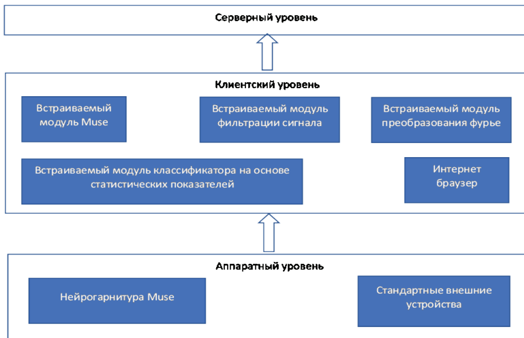
Рис. 2. Схема аппаратно-программного комплекса оценки уровня когнитивной нагрузки
