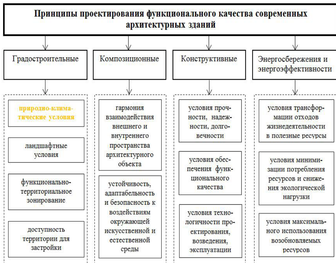
Рис. 1. Принципы разработки (проектирования) архитектурных решений, необходимых для достижения функционального качества современных зданий
