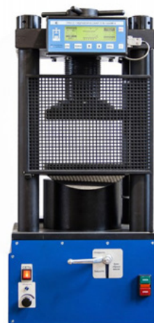
Рис. 2. Испытательное оборудование ПГМ-500МГ4
