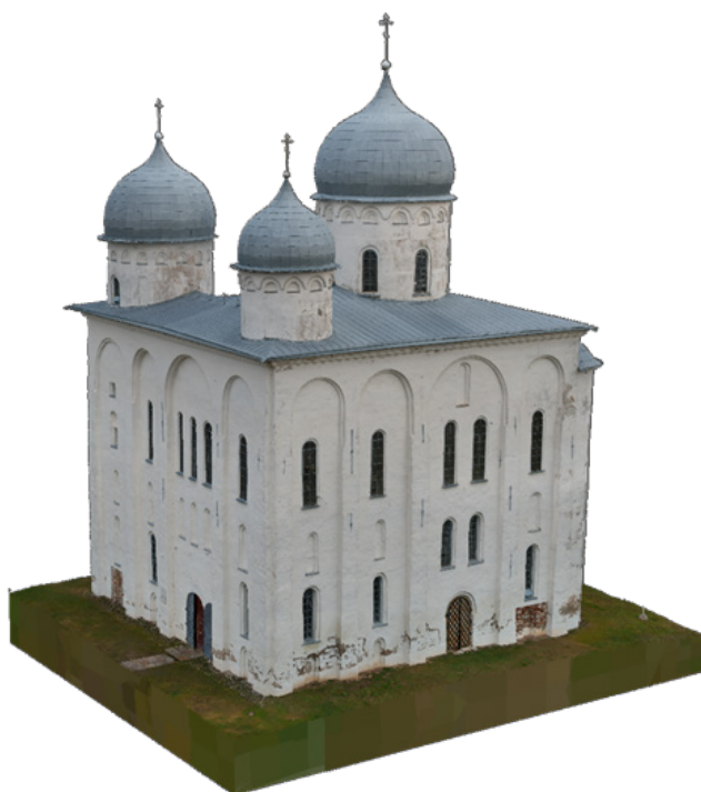
Рис. 2. Текстурированная полигональная модель в Reality Capture
