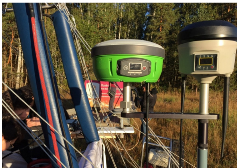
Рис. 3. Закрепленная на МАИС аппаратура МР-8 и МР-10
