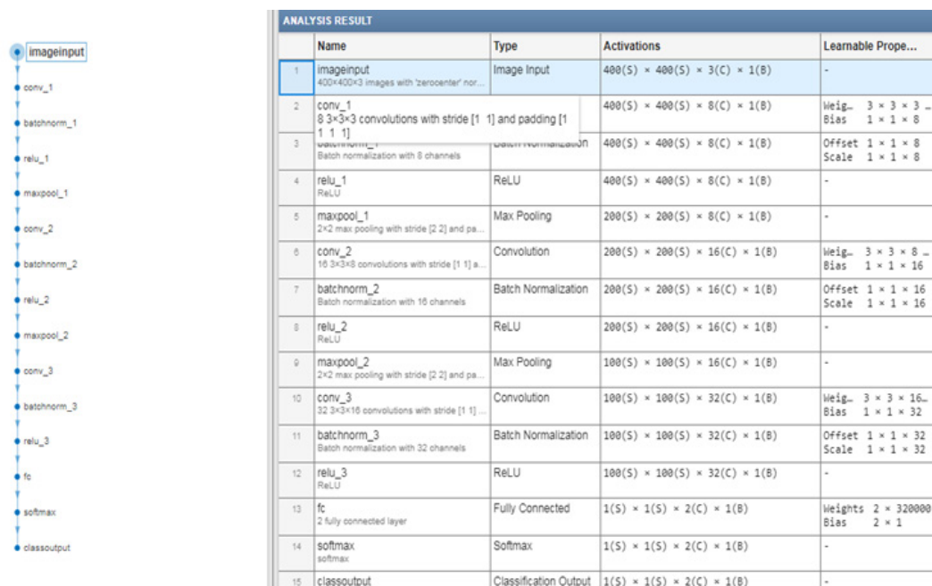
Рис. 8. Структура сверточной сети
