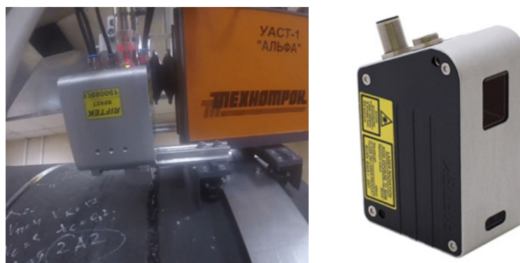
Рис. 3. 2D лазерный сканер RF726 фирмы RIFTEK, смонтирован на сварочной установке
