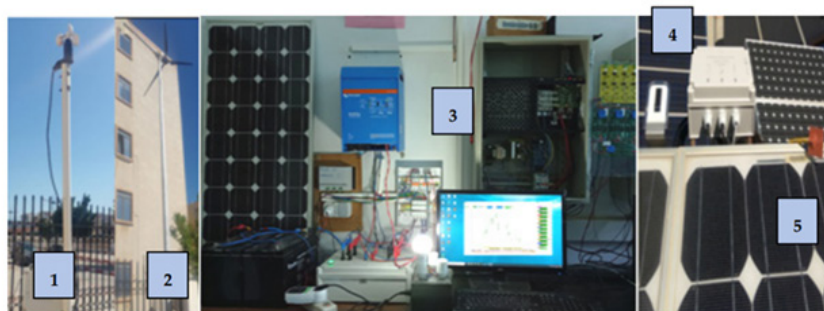
Рис. 4. Устройство для сбора данных измерений в лаборатории: 1 – датчик скорости ветра; 2 – ветряная турбина; 3 – система сбора данных; 4 – датчик солнечного излучения и температуры окружающей среды; 5 – фотоэлектрическая панель, по данным Д. Рекиуа с соавторами [19]
