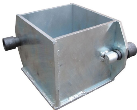
Рис. 1. Форма для изготовления образцов по ГОСТ 22685
