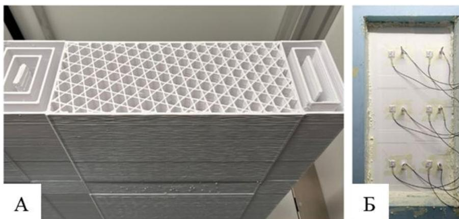
**Рис. 2.** Подготовка образцов PETG к тепловым испытаниям:
