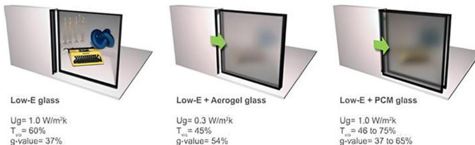
Рис. 2. Визуализация концепции инновационного фасадного модуля с двумя активными слоями, скользящими спереди или сзади, обеспечивает статическое остекление с низкой селективностью по результатам *Iennarella* [1]
