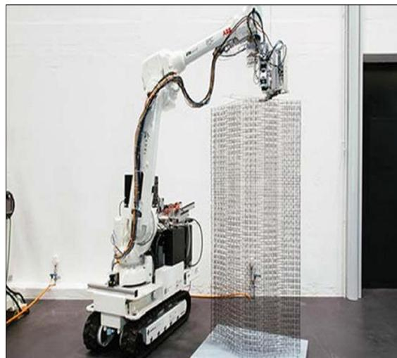
Рис. 2. Мобильный 3D-принтер на шасси компании Branch Technology, США [6]
