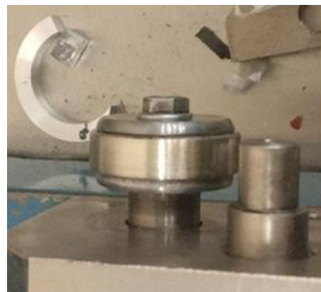
Рис. 4. Ролик с покрытием, нанесенным методом ФАБО
