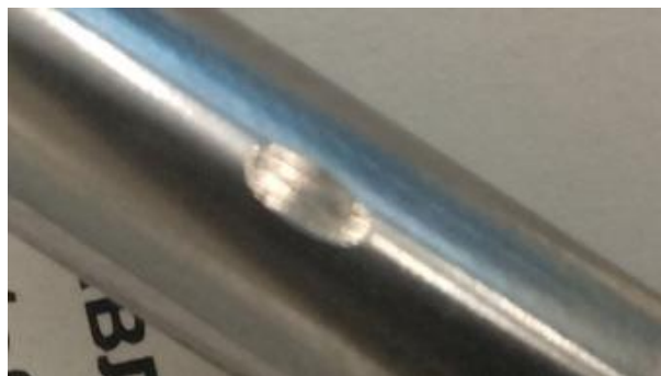
Рис. 6. Площадь износа заготовки при использовании ФАБО
