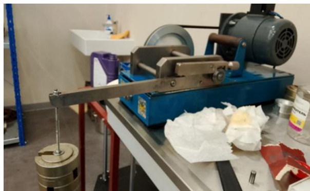
Рис. 2. Машина трения MT10 и нагружение ее 4 грузами массой 0,1 кг (эксперимент без использования нанесения ФАБО)
