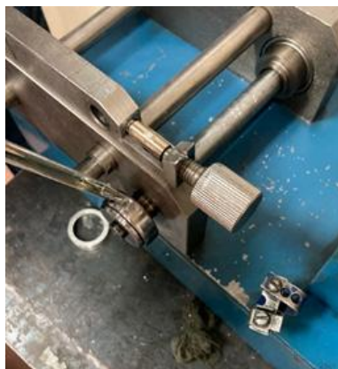
Рис. 3. Покрытие ролика технологической жидкостью (2 массовые части глицерина и 1 массовая часть 10 % раствора соляной кислоты)
