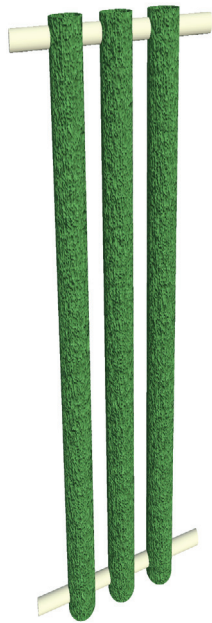
Рис. 3. Кассета с тремя единичными элементами петельной биоагрузки в сборе
