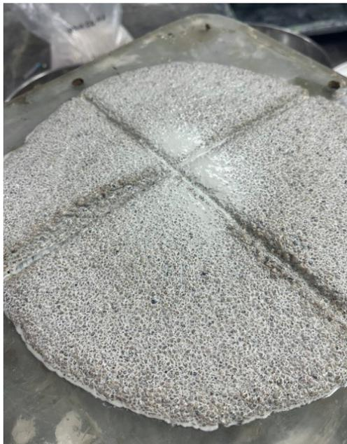
**Рис. 4.** Фото цементно-песчаного раствора на основе белого цемента с добавкой «КРАТАСОЛ ФОРМ» при определении диаметра расплыва с использованием конуса Хеггерманна
