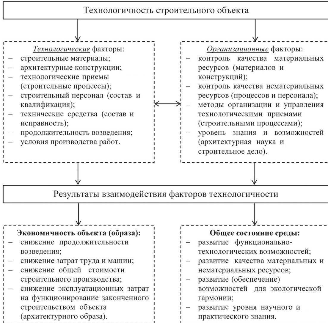
**Рис. 4.** Характеристика факторов свойства технологичности быстровозводимых строительных объектов
