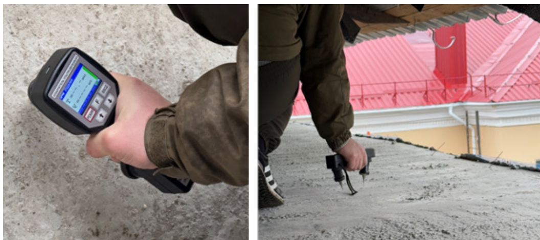
Рис. 1. Измерение прочности бетона ультразвуковым прибором
